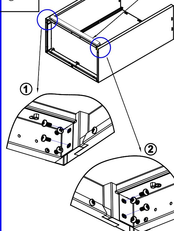
5 Зафиксировать порог на корпусе шкафа при помощи 8-и винтов
