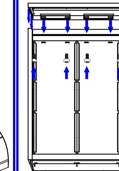
Перед установкой крыши приварные уголки при необходимости отогнуть. Пространство между отгибами при необходимости прочистить от излишков краски. Устанавливать крышу равномерно, до характерного щелчка. Зафиксировать крышу при помощи 4-х винтов.
